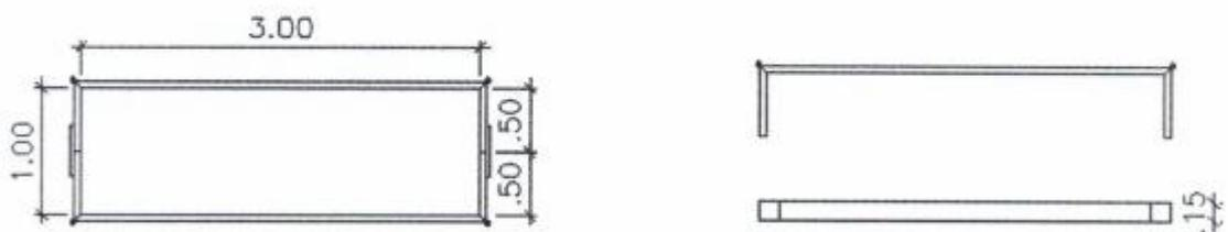
Imagem 01 - Representação da Forma para a Fabricação de Placas em Concreto Armado
